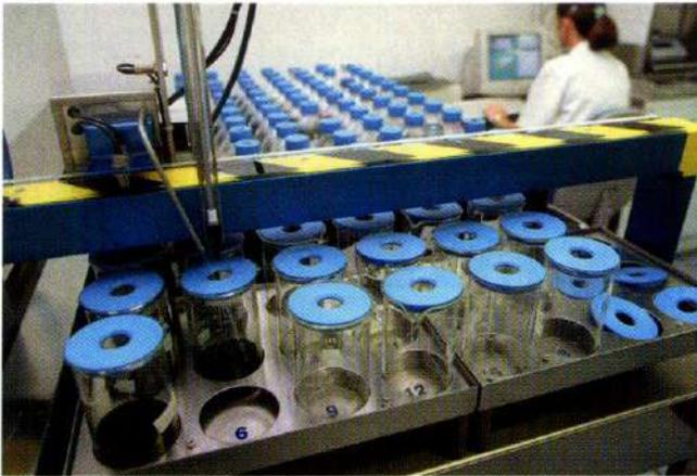
Equipo de laboratorio para la preparación automática de baños de tintura
