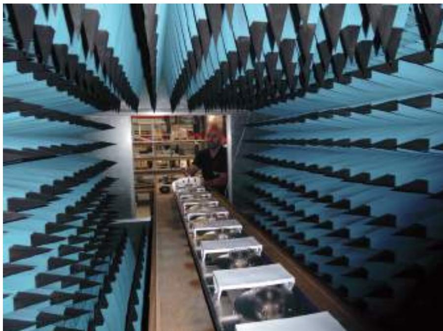
Comprobación de parámetros radioeléctricos de antenas en cámara semianecóica
