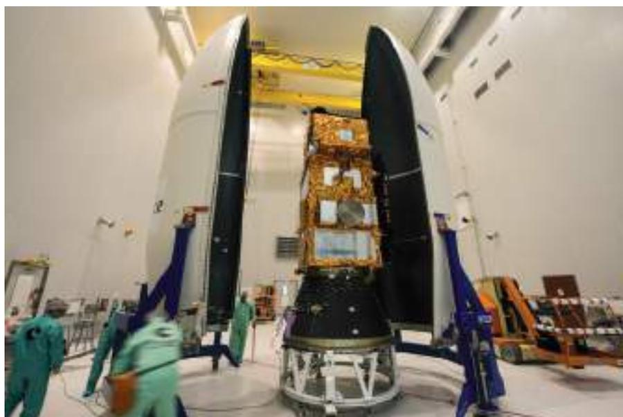
El Sentinel-2A es cargado en la cápsula del lanzador Vega que lo pondría en órbita (Foto: ESA)
