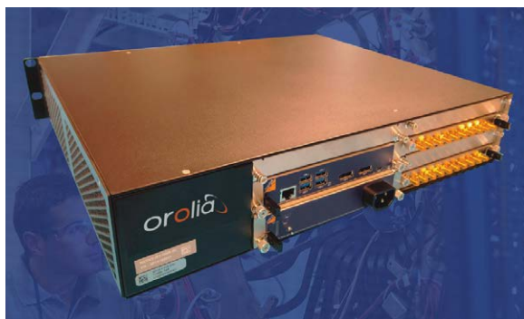
uTCA Beam Position Monitor
